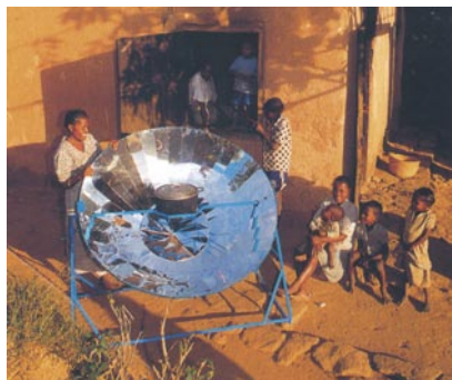
↓ Le cuisiner solaire, de plus en plus répandu dans les PED, concentre les rayons du soleil pour faire cuire la nourriture. Particulièrement économique, il sert aussi bien de four que de plaque de cuisson. http://solarcooking.org/francais
